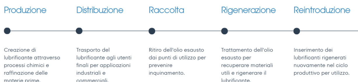
Figura 1 – schema ciclo via del lubrificante
